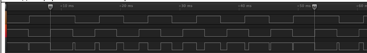
Таймер 6 считает 10 импульсов и сбрасывает Таймер 2 и Таймер 4
