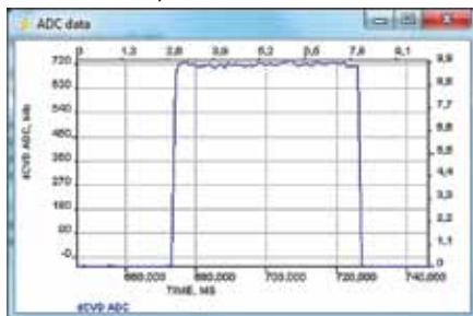
Рис. 53. Реакция на касание сенсорной кнопки при дифференциальном CVD
