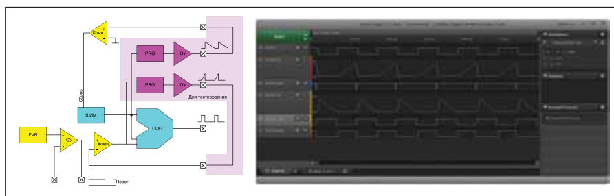
Рис. 34. Пример формирования пилообразных сигналов, для отладки ШИМ-контроллера с измерением пикового значения тока и детектированием нулевого тока в индуктивности
