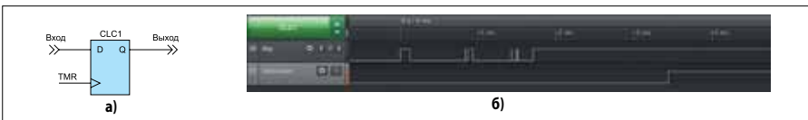
Рис. 11. Подавление дребезга: а) схема; б) диаграммы сигналов на входе и выходе схемы
