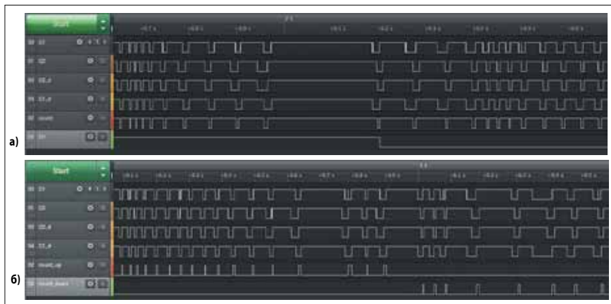
Рис. 15. Диаграммы сигналов обработки квадратурного энкодера для схем: а) с выходом направления; б) с двумя счетными выходами
