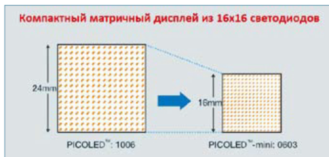
Рис. 2. Матричный дисплей из 256 светодиодов PICOLED™-mini с шагом 1 мм
