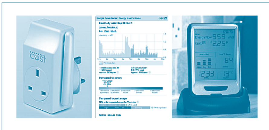
Рис. 1. Беспроводной датчик мощности производства Current Cost, интерфейс Google PowerMeter, панель индикации счетчика электроэнергии Current Cost (слева направо)
