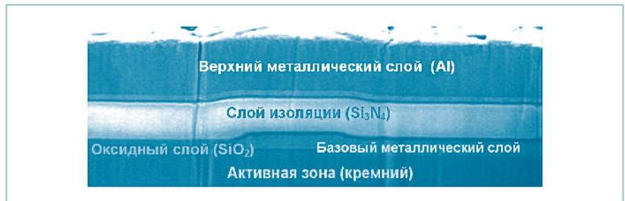
Рис. 1. Зона эмиттера транзистора BISS в разрезе
