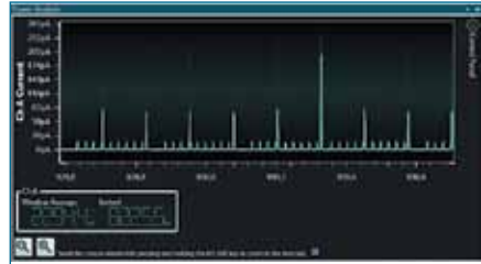
Рис. 14. Средний ток потребление при использовании Analog-On-Demand
