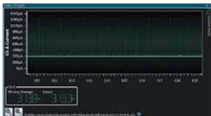
Рис. 12. Средний ток потребления микроконтроллера при работе с OPAMP2
