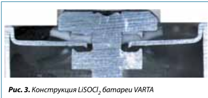
Рис. 3. Конструкция \text{LiSOCl}_2 батареи VARTA
