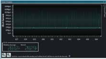
Рис. 13. Средний ток потребления при отключении удвоителя напряжения
