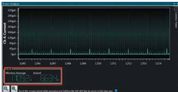
Рис. 7. Энергопотребление в режиме STANDBY при работе по схеме 4а
