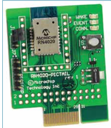
Рис 4. Отладочная плата RN4020 Bluetooth Low Energy «PICtail/PICtail Plus»
