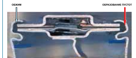
Рис. 4. Конструкция LiSOC12 батареи большинства производителей
